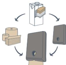
Grâce à un **procédé exclusif** et mécanique, Lucart parvient à séparer les matériaux des briques alimentaires afin de les recycler totalement. Les fibres de cellulose, dont la qualité est similaire à de la pure ouate, deviennent le **Fiberpack®**, dont sont faits les produits d'essuyage EcoNatural. L'aluminium et le polyéthylène deviennent l'**AI.Pe.®**, utilisé notamment pour fabriquer les appareils EcoNatural Flow.
